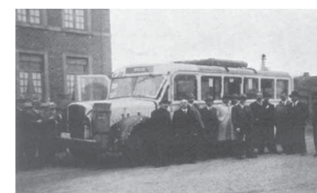
Недостигът на дизел по време на Втората световна война кара Белгия да зарежда автобусите с комбинация от амоняк и въглищен газ
